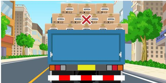
装载时,装卸人员要注意使货物质量尽可能均匀地分布于载货平面,沿车辆纵向往中心线均衡顺装,较重的物件尽量放置于车厢的中部,尽量降低整车重心位置。
