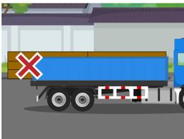
对于流体货物和松散货物,所选择的运输车辆应具备能够完全容纳货物的货厢,货厢的结构和设计应尽可能减少货物在货厢内的移动,以降低由此带来地对车辆行驶稳定性的影响。
