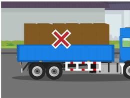
松散货物的运输车辆车厢顶部应具备密封装置,或者使用防水布将货物覆盖,以避免货物遗撒或淋雨。流体货物运输车辆的罐体内部应尽可能地设置隔板,防止流体货物未全部充满罐体时,部分流体在罐体内流动对车辆造成的冲击。
