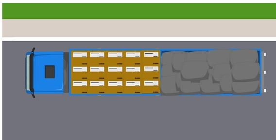
4 根据货物特性、车辆货厢结构与加固点选择填充、货物加固装置,并对货物施加适当的约束。对西瓜、蔬菜等散装货物之间的空隙可以使用稻草、纤维等填充物,防止碰撞、移动。对起脊装运的成件包装货物或袋装货物采用绳网加固,对大型货物采用阻挡和栓紧带等装置加固,并根据相关标准的规定对货物施加约束力,防止货物窜动、倒塌和坠落。
